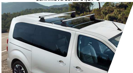
Priečny strešný hliníkový nosič – 1 ks. strešné tyče z anodizovaného hliníka. Upevnenie do kotviacich bodov v streche. Max. záťaž: 100 kg/2nosiče, 150kg/3nosiče. Číslo dielu: 1612491580 Cenniková cena: 208,84 €
